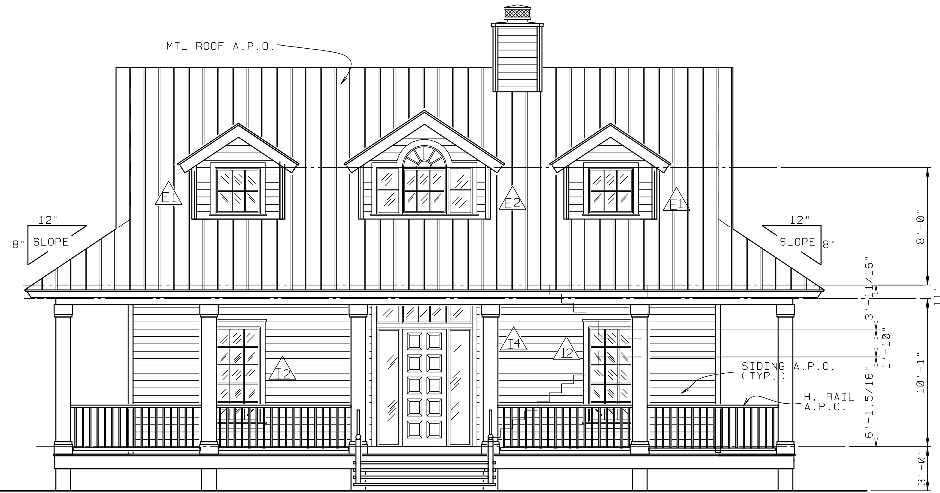
FRONT ELEVATION - SCALE: 1/4" = 1'-0" -
